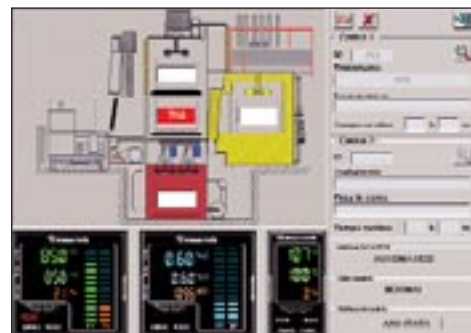
L'interfaccia operatore riporta le cariche, i trattamenti, gli stati e i valori di processo più importanti di ogni impianto.
